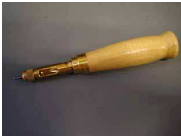
Fig. 2. Instrument anvendt til at udtage prøver til pH-måling med.
